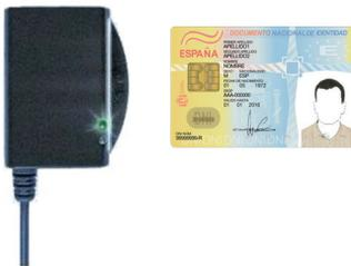
El lector (que debe cumplir el estándar ISO-7816<sup>3</sup>) debe conectarse de manera correcta a un ordenador. La tarjeta tiene que insertarse por el lado del chip, como se opera, por ejemplo, en un cajero electrónico.
